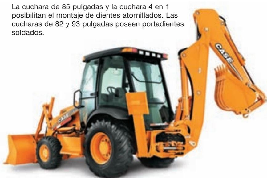
La cuchara de 85 pulgadas y la cuchara 4 en 1 posibilitan el montaje de dientes atornillados. Las cucharas de 82 y 93 pulgadas poseen portadientes soldados.
