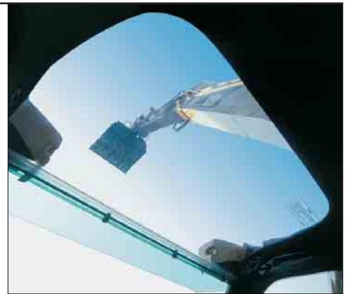
**Claraboya.** La claraboya de policarbonato de gran tamaño, que proporciona excelente visibilidad hacia arriba, resulta especialmente útil en las aplicaciones sobre el nivel del suelo.
