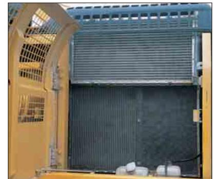
**Radiador y Enfriador de Aceite.** A través de la puerta de servicio trasera izquierda se accede fácilmente al radiador del motor y al enfriador de aceite que, para mayor facilidad de limpieza, están juntos uno al lado del otro. Y para facilitar el mantenimiento, el depósito de reserva y el grifo de vaciado están unidos al radiador.
