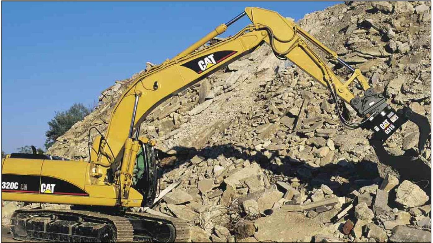
**Plumas y Balancines.** Contruidos para proporcionar altas prestaciones y tener una gran duración, las plumas y balancines Caterpillar están compuestos por grandes estructuras de sección en caja, soldadas, y conjuntos de planchas múltiples en las zonas sometidas a mayores tensiones.
