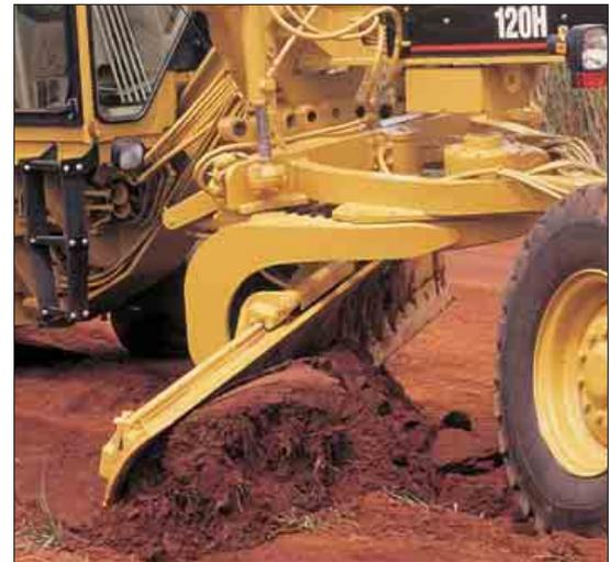
**Hoja.** Fabricada con acero termotratado de alta resistencia, cuchilla de ataque curva y cantoneras de acero DH-2 endurecido y bandas de desgaste metálicas reemplazables que garantizan su fiabilidad y larga duración. Para mayor flexibilidad, el soporte para el desplazamiento lateral de la hoja opcional puede colocarse en tres posiciones.
