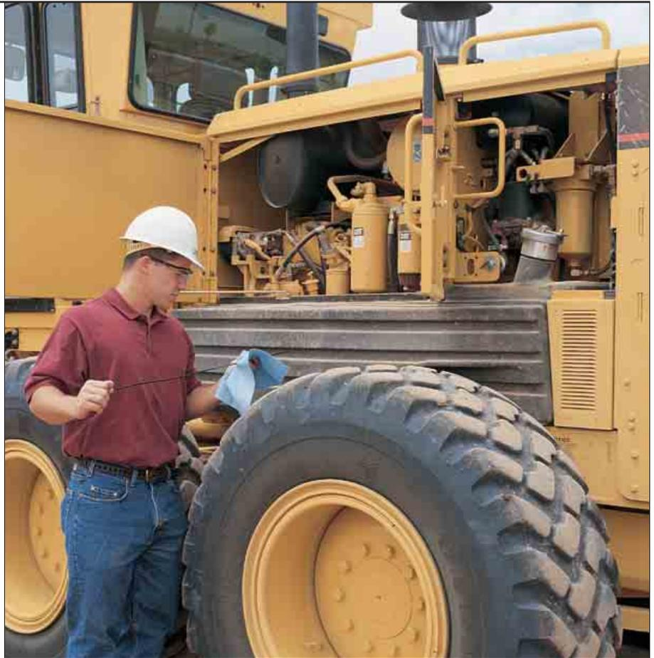
**Intervalos de Cambio de Aceite más Largos.** El intervalo de cambio del filtro y del aceite motor ha aumentado hasta 500 horas, el de aceite hidráulico hasta 4000 horas y el de refrigerante hasta las 6000 horas, lo que reduce los tiempos y costes de mantenimiento de la máquina.
