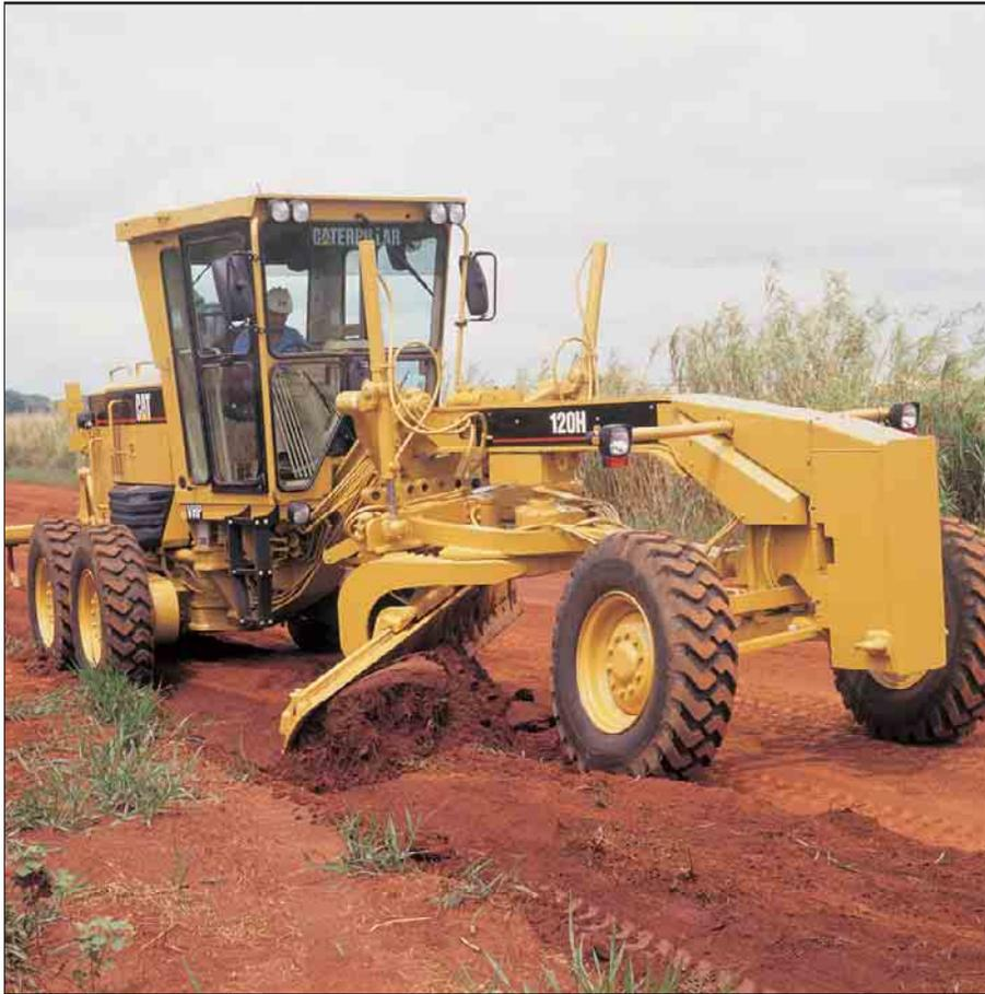
**Cabina Silenciosa.** El montaje elástico del motor y de la transmisión reduce los niveles de ruido y las vibraciones dentro de la cabina. Los niveles de ruido en el interior de la cabina, que no sobrepasan los 75 dB(A), medidos según especifica la Norma ISO 6394, mejoran las condiciones de trabajo del operador.
